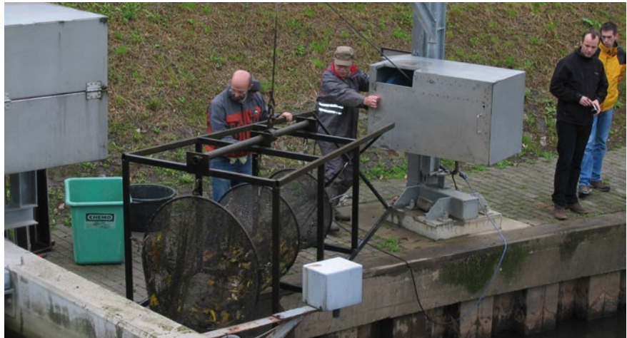
Bild 6: Heben des Hamens, mit dem der Abstieg durch den sohlennahen Bypass überwacht wird
